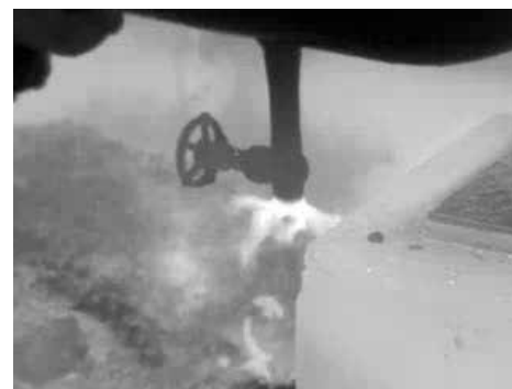
Z tego zaworu wydostaje się etylen, widoczny jako biały dym na ciemnym obrazie termicznym.
