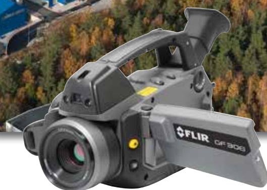
Kamera FLIR GF306 do optycznego obrazowania gazów umożliwia wizualizację wycieków gazów w czasie rzeczywistym.
