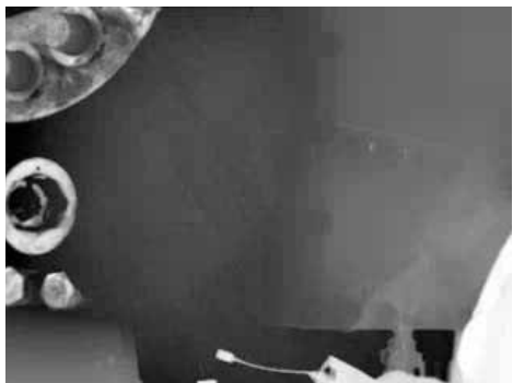
Aby wykryć wyciek gazu, należy skierować detektor dokładnie w kierunku jego lokalizacji. Kamery do optycznego obrazowania gazów potrafią wykrywać wycieki gazów w dowolnym miejscu znajdującym się w ich polu widzenia.
