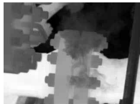
Wycieki są prezentowane na obrazie wideo w postaci oparów przypominających ulatujący dym.
