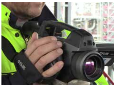
Kamera GF306 do optycznego obrazowania gazów jest przyrządem kompaktowym, dość lekkim i zaprojektowanym z myślą o ergonomii, aby zapobiec urazom pleców i ramienia.
