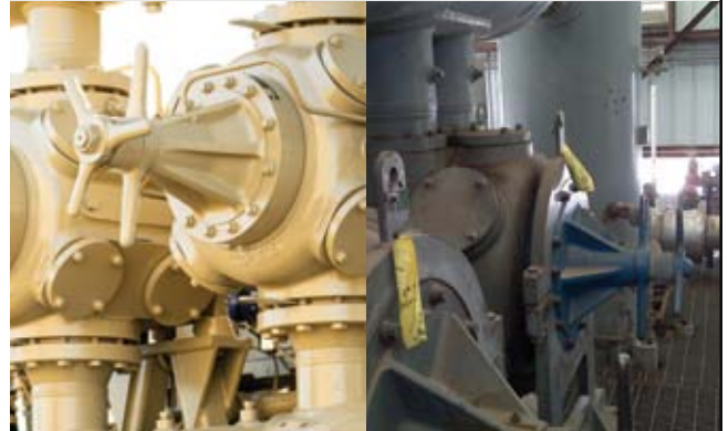
압축기 외부에서 고장 난 부분이 눈에 보이지 않으면, 가스 누출 지점 파악이 상당히 어려워질 수도 있습니다.
