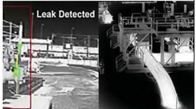
지상 송유관 시설의 안전은 실화상과 열화상 센서를 조합했을 때, 가장 효과적으로 모니터링이 가능합니다.
