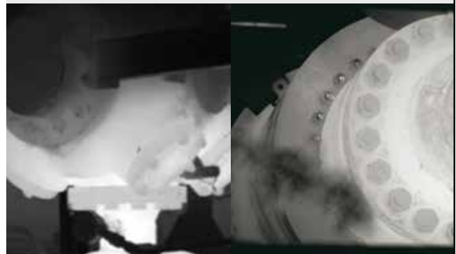
Una cámara OGI hace que resulte más seguro y eficiente detectar fugas de gas de los compresores.
