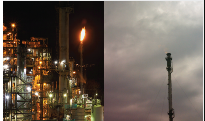
Zum Überwachen von Abfackelvorrichtungen werden verschiedene Technologien eingesetzt. Diese funktionieren jedoch nur eingeschränkt, wenn sie durch Rauch hindurchsehen müssen.
